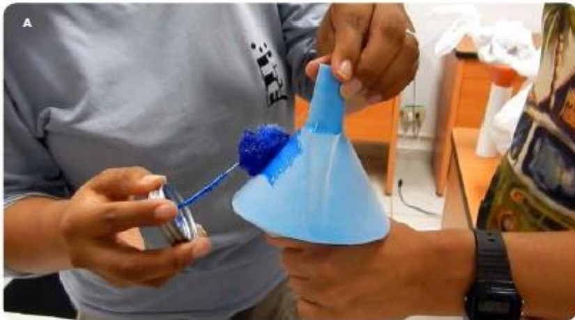
FIGURA 1.3. Proceso de pegado de embudos. (A) Aplicación de pegamento a embudo A y red. (B) Aplicación de pegamento a la cara interior del embudo B. (C) Ensamble del embudo A, la red y el embudo B (D) Aspecto final.
