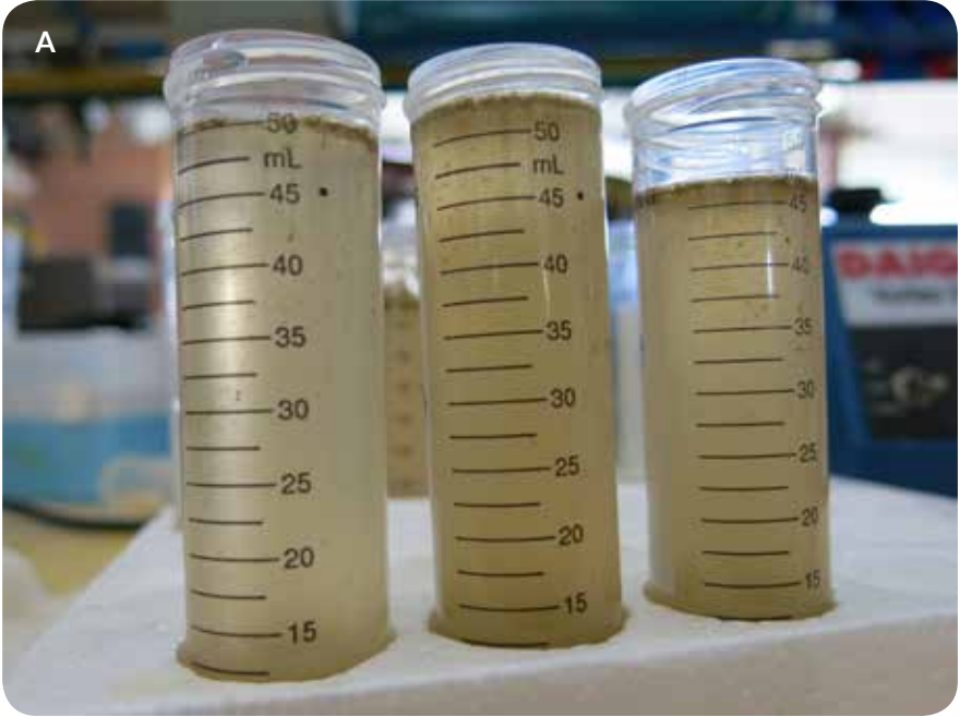
FIGURA IV.2. (A) Tejido homogenizado transferido a tubos Falcon. (B) Extracto centrifugado. (C) Lavado del pellet.
