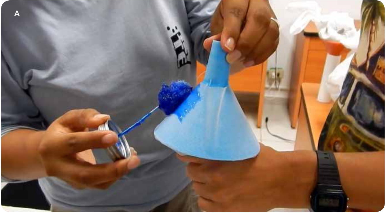
FIGURA I.3. Proceso de pegado de embudos. (A) Aplicación de pegamento a embudo A y red. (B) Aplicación de pegamento a la cara interior del embudo B. (C) Ensamble del embudo A, la red y el embudo B (D) Aspecto final.
